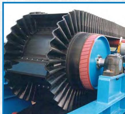
Construction robuste utilisant deux roulements scellés montés sur des arbres d'acier ou d'acier inoxydable de 1 1/4". Les arbres peuvent être filetés ou allongés selon vos besoins.
